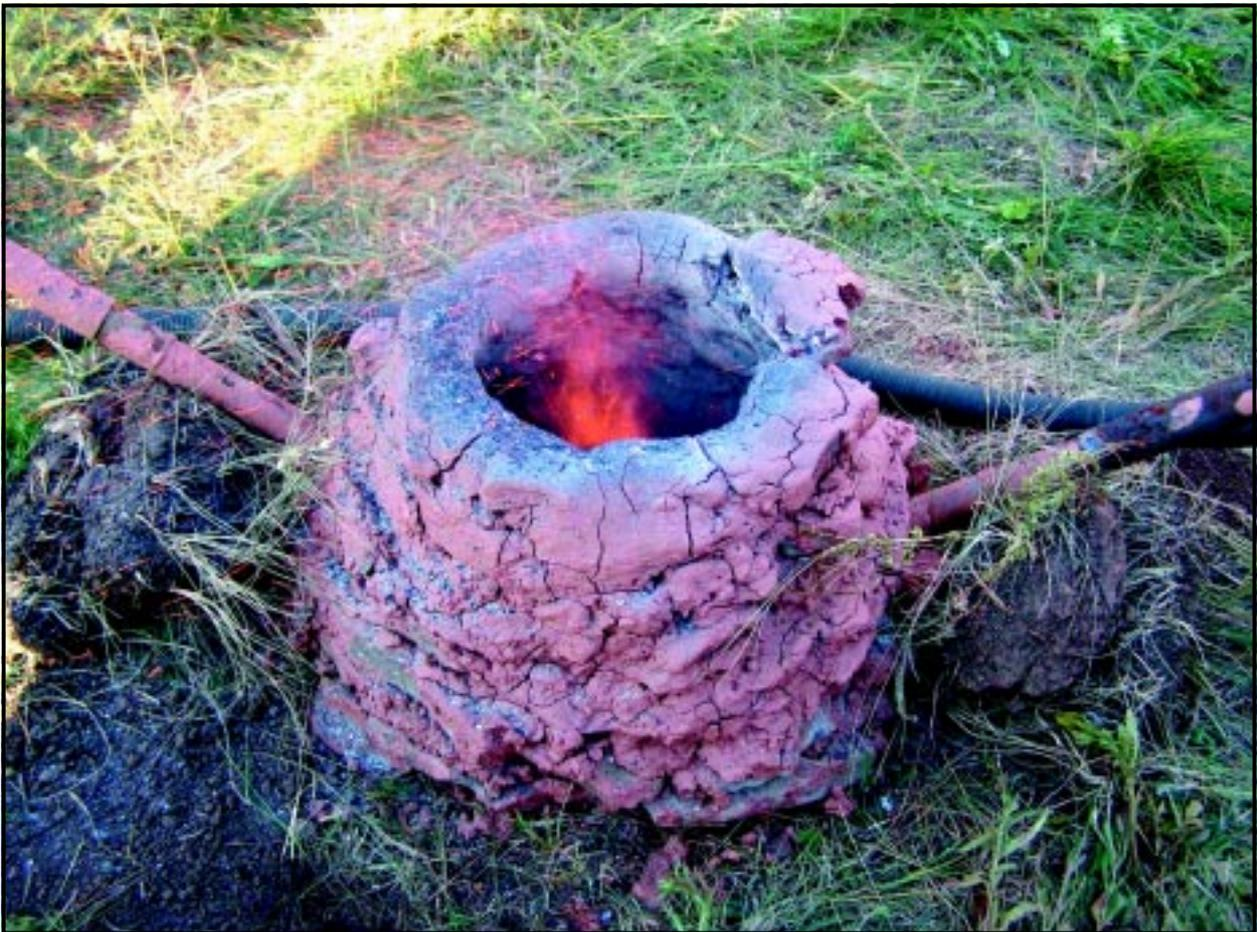
**Рис. 2.** Экспериментальная печь конусовидной формы (картамышский тип)
