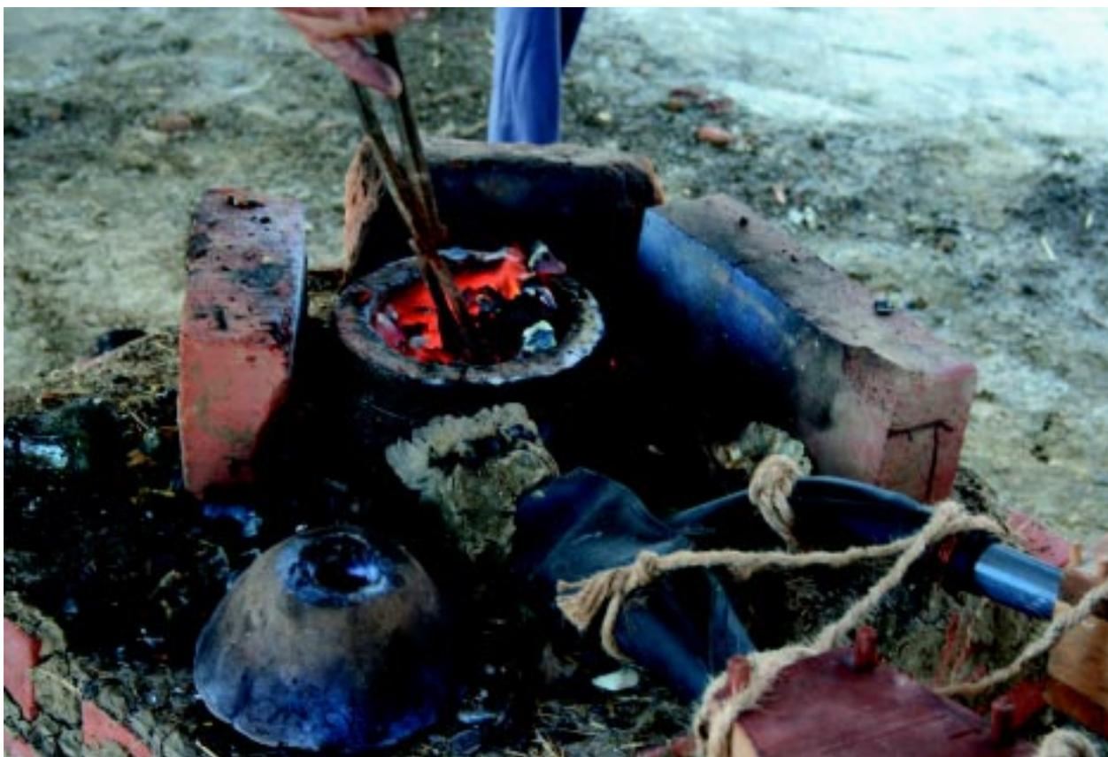
Рис. 13. Портативная плавильная печь в зоне 2 экспериментальной площадки в процессе плавки бронзы.
