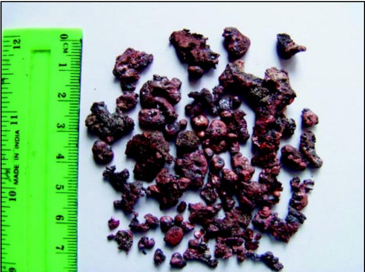
Рис. 6. Продукт металлургической выплавки сульфидной руды (эксперимент № 2 2006 г.)
